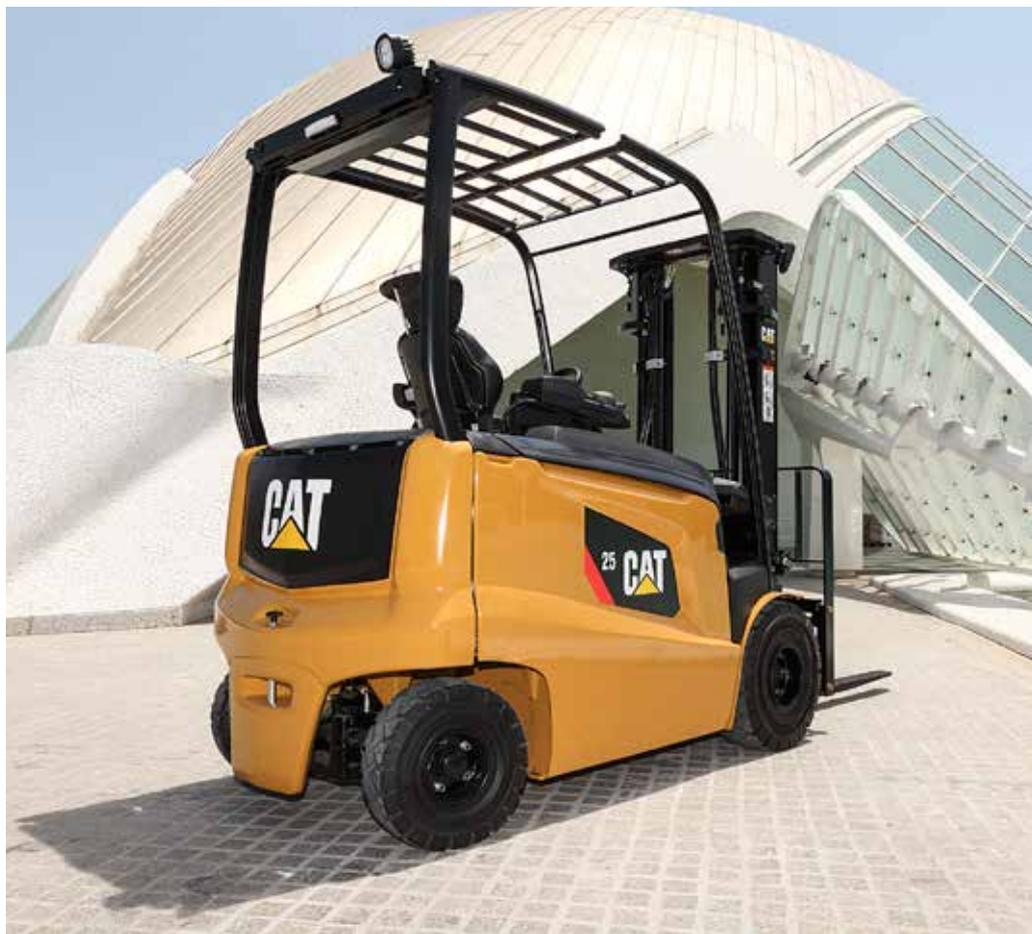
комфорта при вождении и транспортировке груза, но и впечатление, что машина «знает», как поведет себя оператор в любой момент времени. Система адаптирует реакцию погрузчика на движения оператора. Интеллектуальная система контроля скорости машины на поворотах позволяет плавно выполнять маневры без ощущения, что она наклонилась, что повышает
