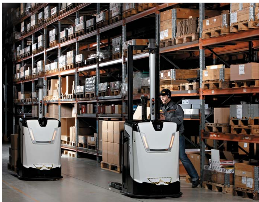
Подбор грузов с помощью AGV и системы pick-by-voice
