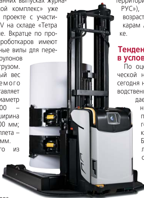
Первый в мире серийно выпускаемый автоматизированный погрузчик Rocla. 2007 г.
